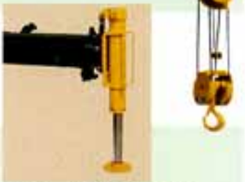
6段ブーム機は、回転式リヤアウトリガを標準装備。(最大張出し幅: 2,890mm)
