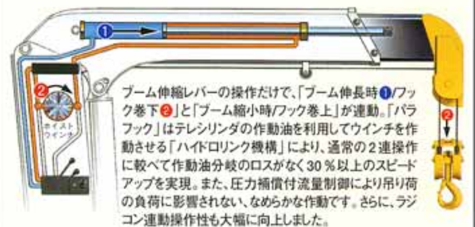
世界初、油圧式フック自動連動機構「パラフック」概念図
