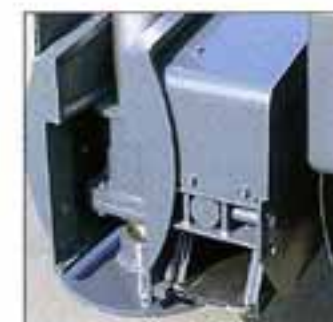
●アウトリガ張出し幅自動 検出装置
