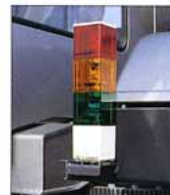
●ACSコンピュータロード外部表示灯
