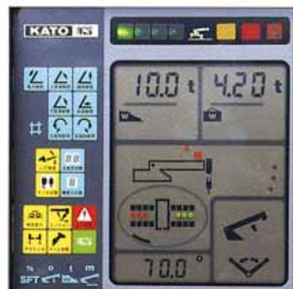
●アウトリガ張出幅自動検出装置と作業範囲制限機能付モーメントリミッタ
