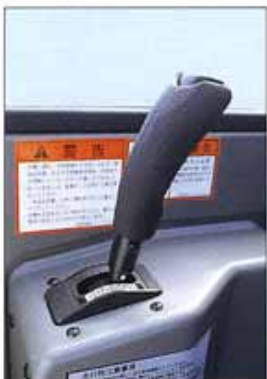
●電子制御自動ロックアップ オートマチックトランスミッション
