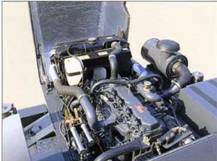
●低燃費・低騒音を両立。強力な160PSインタークーラー付ターボエンジン
