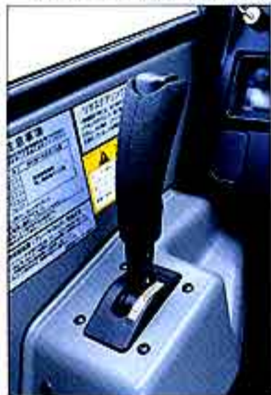
●電子制御フルロックアップ オートマチックトランスミッション
