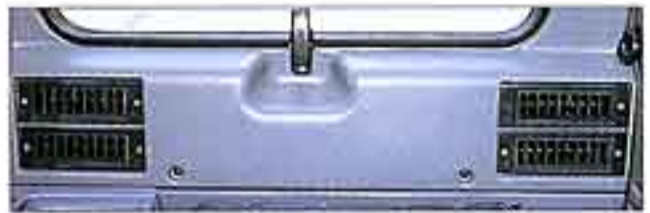
●エアコン吹出口
