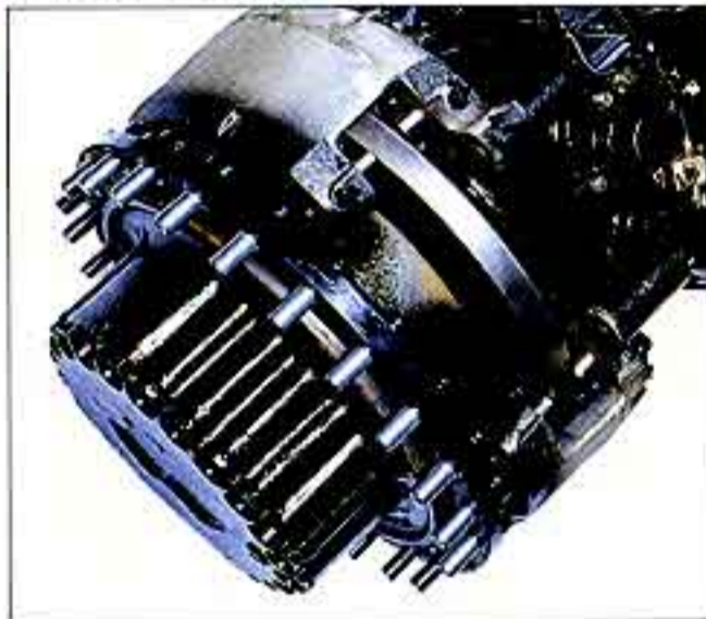
●信頼性の高い大型ダブルキャリア付 全輪ディスクブレーキ
