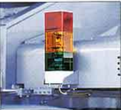
●ACSコンピュロード外部表示灯
