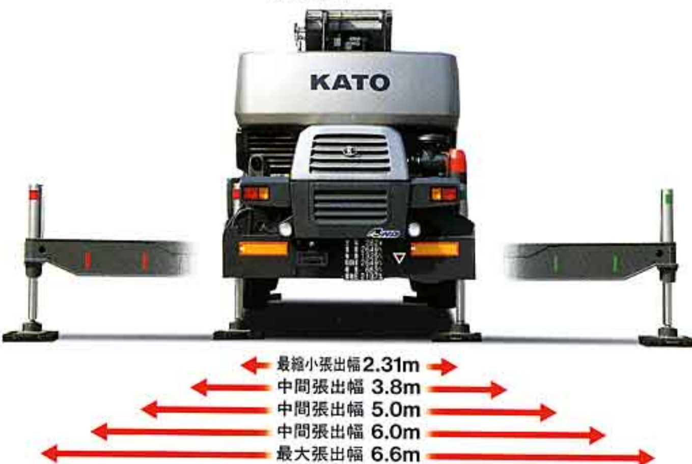
●アウトリガ張出し幅自動検出装置
