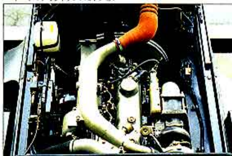
●低燃費・低騒音を両立、強力な250PSインタークーラ付ターボエンジン
