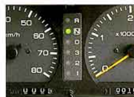
●A/Tポジションインジケータ付パネル
