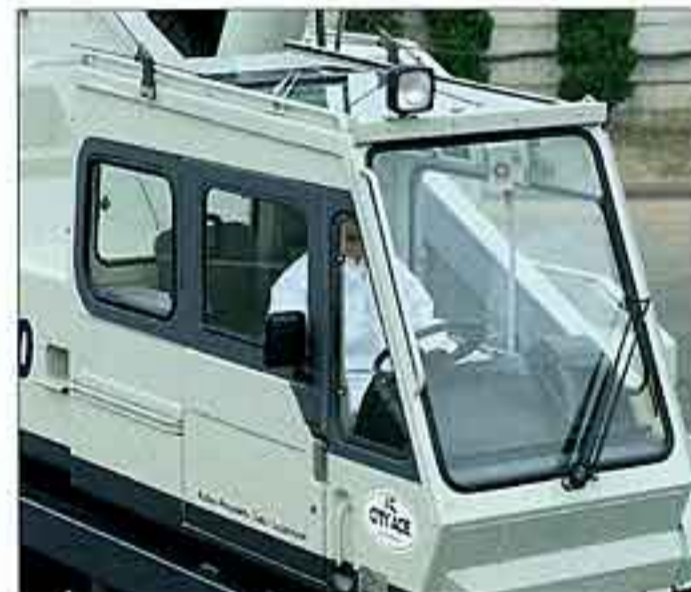
●視界がよりクリアになった（ウォッシャ付）フロント・ルーフウィンド大型ワイパー
