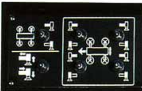
● キャリア部アウトリガコントロールパネル （夜間照明付）
