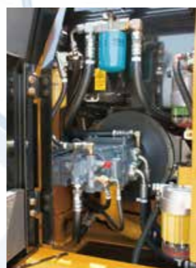
▲メンテナンスの容易なフィルタ配置
