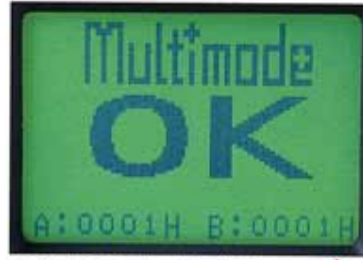
●全てのモニターが正常で作動中に表示。 A, Bのサービスメータ表示
