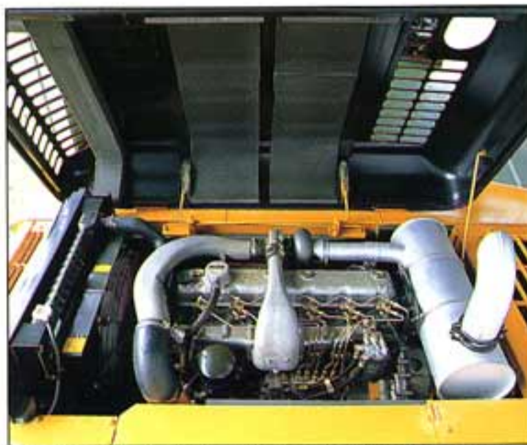
●高出力で低燃費・低騒音、タフで粘り強い125kW(170PS)排出ガス対策型直噴ターボエンジン。
