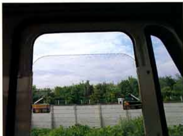
● 直射日光をカットし、まぶしさを防止するブロンズ ガラス
