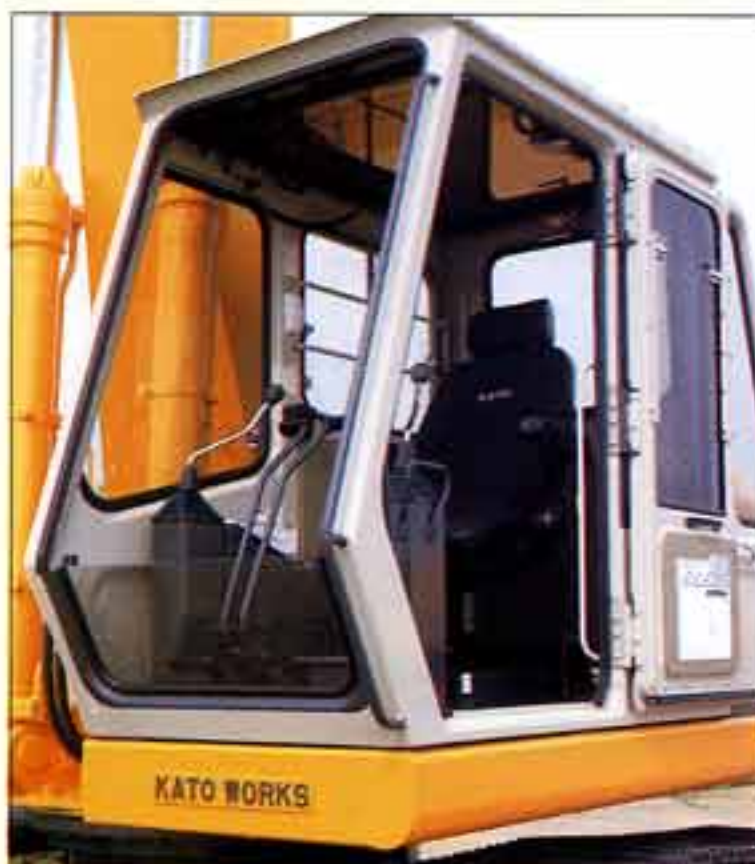
● ISO国際規格サイズ(940 mm )をクリアする大型キャブを採用。
