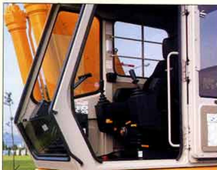
● 応答性にすぐれた姿勢で軽快な操作ができるリストコントロールレバー(オプション)。
