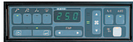
効率の良い作業をサポート 外気導入型のオートエアコン
