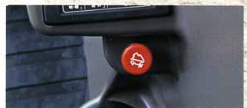
エンジン非常停止ボタン
