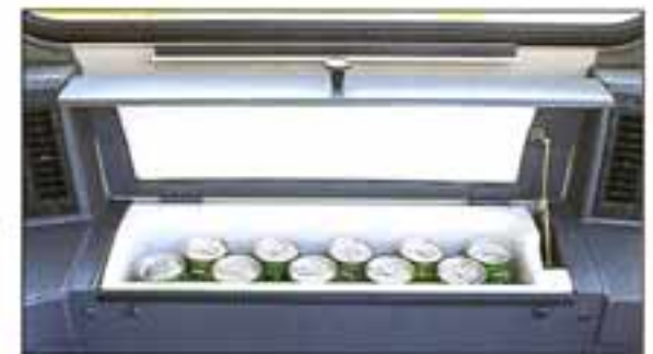
●夏には冷たいジュースやおしぼりを、冬にはホットランチを提供するホット&クールボックス。
