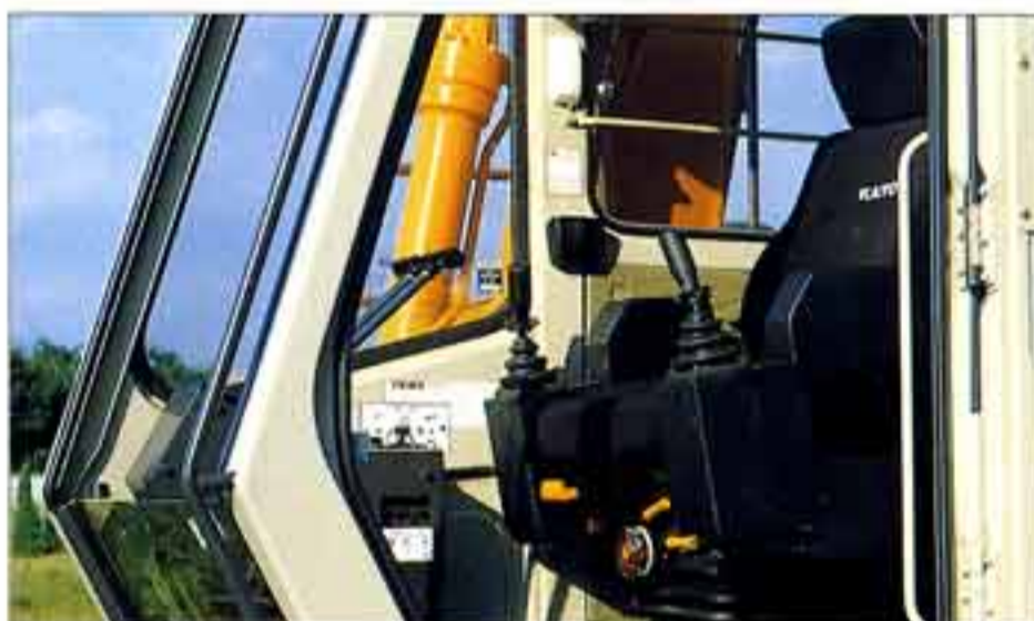
●応答性にすぐれた楽な姿勢で軽快な操作ができるリストコントロールレバー(オプション)
